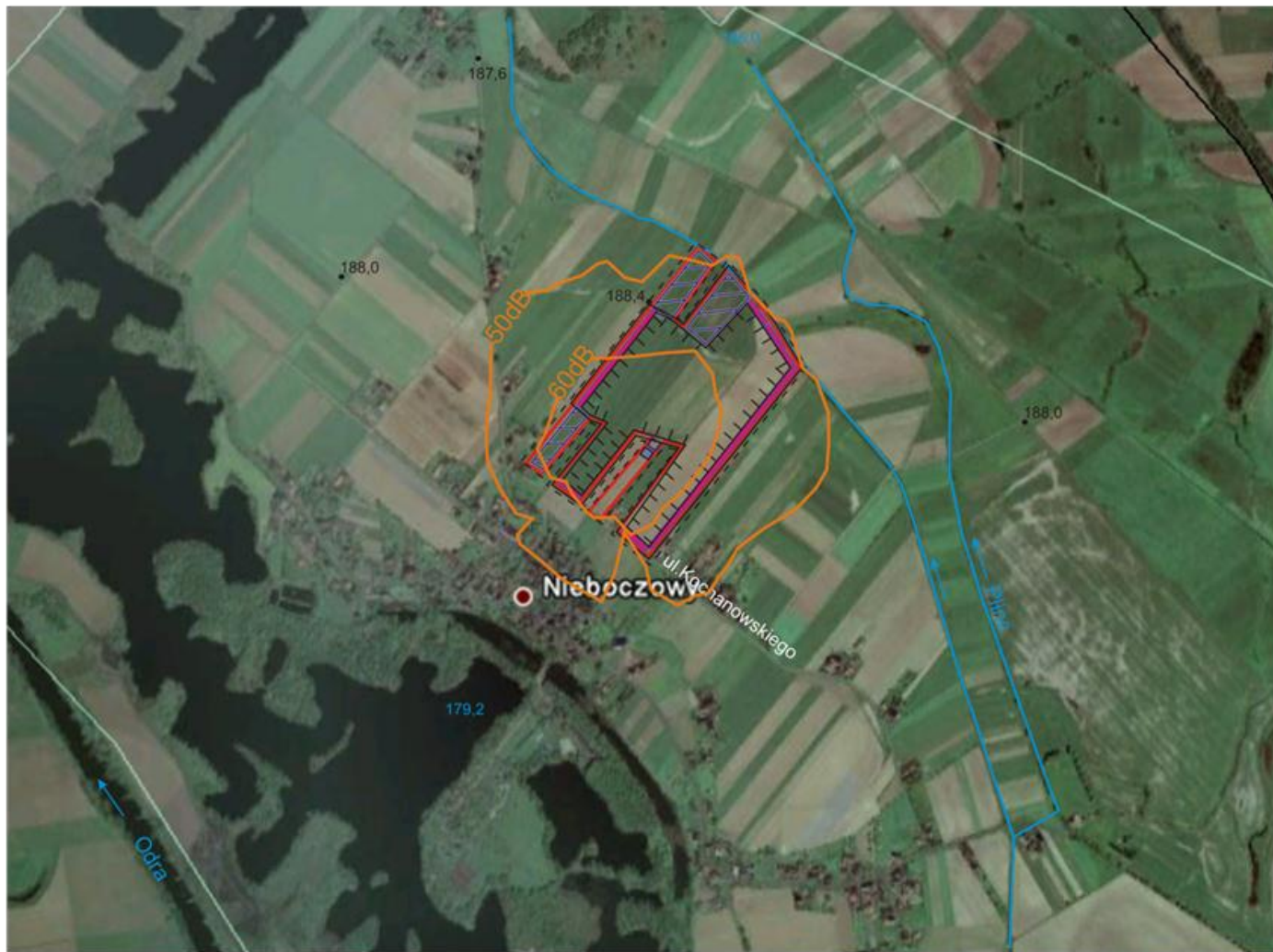
Rysunek 3. Mapa sytuacyjno-wysokościowa prognozowanego zasięgu długotrwałego hałasu wokół projektowanej kopalni „Racibórz II – Zbiornik 4”
